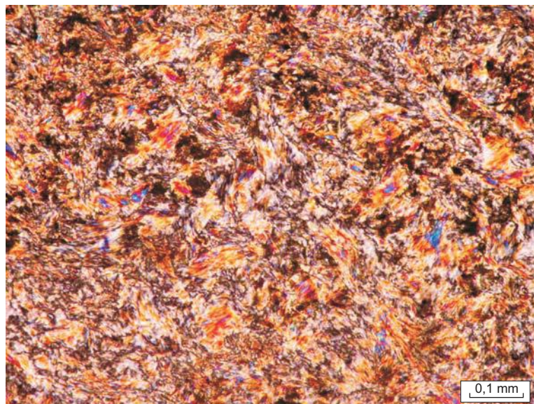
Ryc. 3. Obraz mikroskopowy pierwszej odmiany aktynolitu w nefrycie z Nasławic (nikole skrzyżowane)
