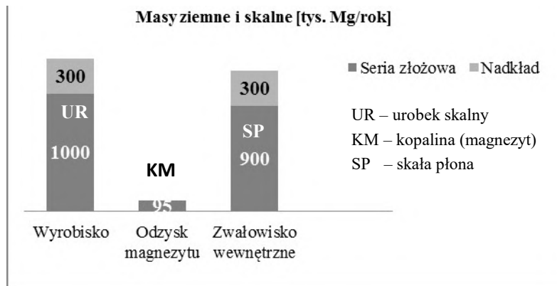
Rys. 5. Bilans mas ziemnych i skalnych i związanych z eksploatacją złoża magnezytu „Braszowice” Fig. 5. The balance of masses of rock and soil related to the exploitation of “Braszowice” magnesite deposits
