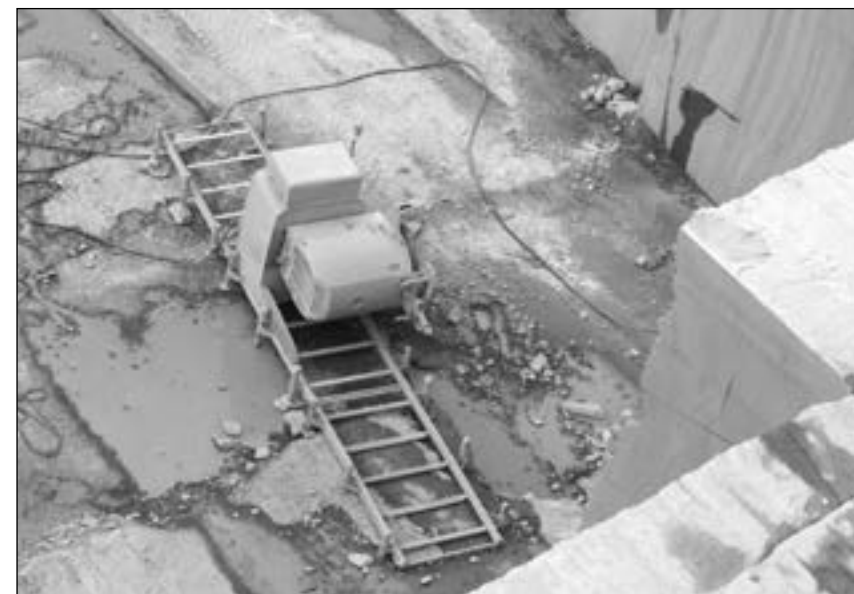
Rys. 5 Wydobycie bloków za pomocą piły linowej. Napęd liny diamentowej na dnie wyrobiska. Powstający pył zostaje w wyrobisku pokrywając lokalnie skały i maszyny nie rozprzestrzenia się na obszary przyległe, zdjęcie wykonane w technice kolorowej, barwy szarości spowodowane pyłem granitowym. (Fot. Jacek Major)
