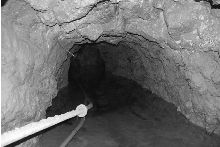
Rys. 3. Częściowo zalane wodą chodniki kopalni „Grochów 1” Fig. 3. The partially flooded headings in the „Grochów 1” mine.
