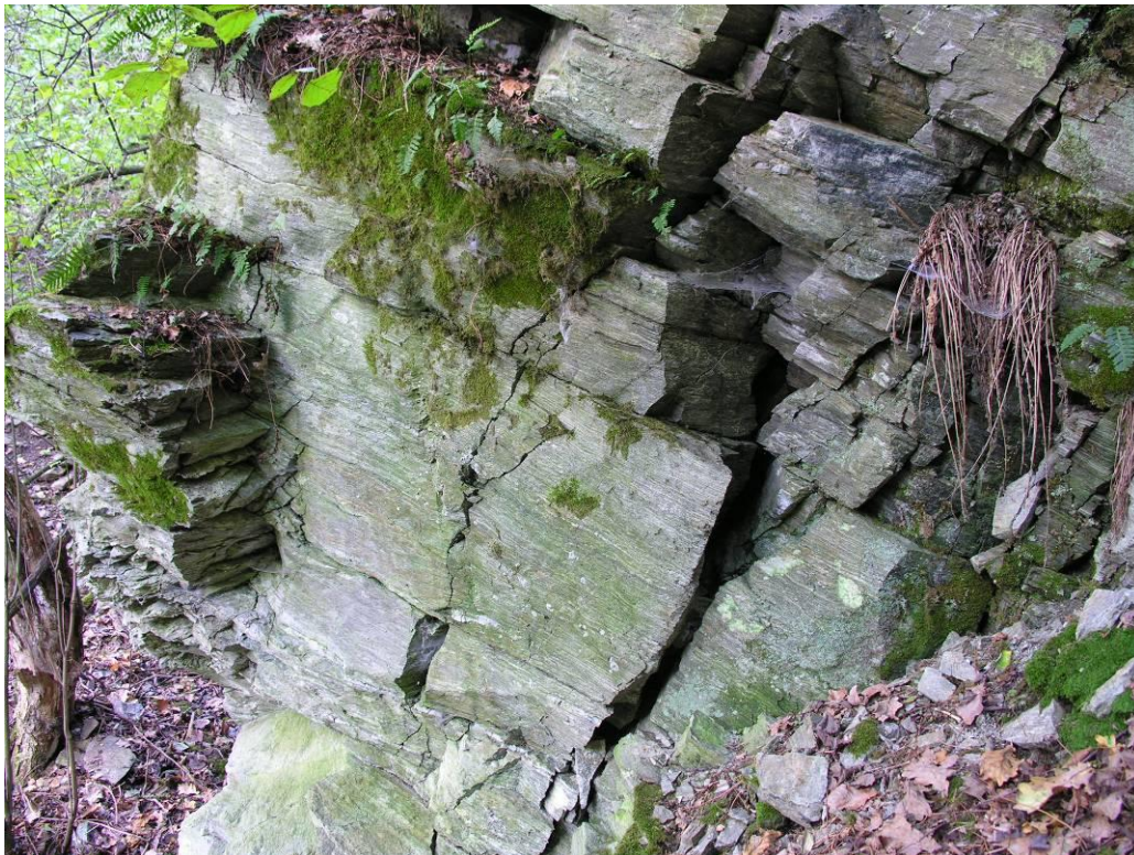
Fot. 4. Fragment ściany wyrobiska z gnejsami o płytowej oddzielności.
