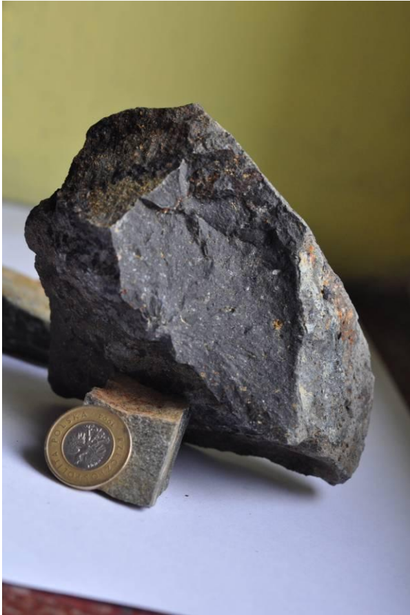
Ryc. 5. Próbkę lawy bazanitowej z widoczną porowatością. Widoczne pustki powstały w wyniku wietrzenia oliwinów.
