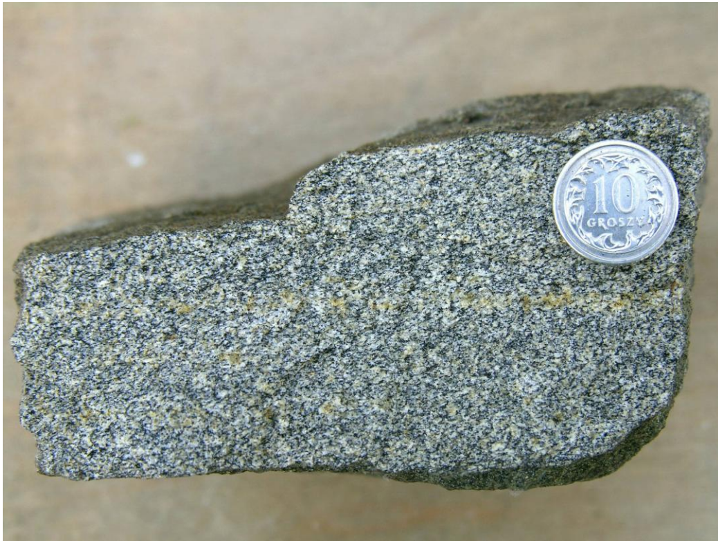
Fot. 5. Próbkę tonalitu z delikatnie zaznaczającą się teksturą kierunkową.
