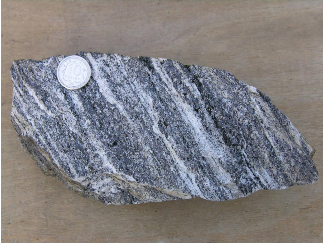
Fot. 3. Próbką gnejsu z dobrze widoczną lineacją na powierzchni foliacji.
